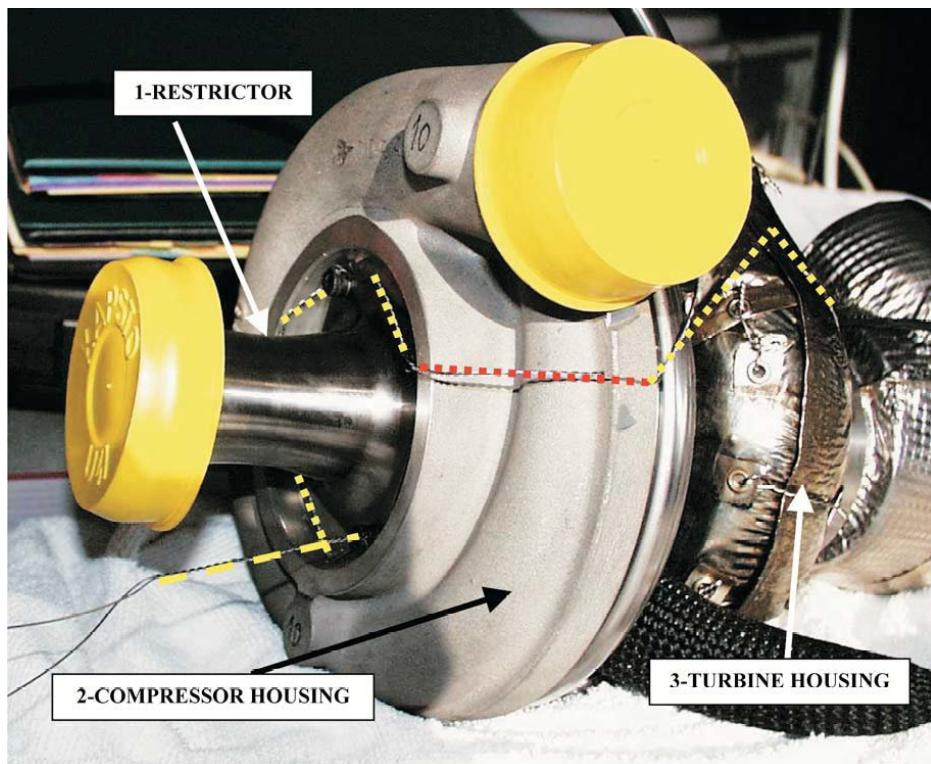
Restruktoram jābūt izgatavotam no viendabiga materiala un to jāparedz caururbt tikai montāžai un plombešanai, kas javeic starp montešanas skruvem, starp restruktoru (vai restruktora/kompresora korpusa stiprinajumiem), kompresora korpusu (vai korpusa/atloka stiprinajumu) un turbinas korpusu(vai korpusa/atloka stiprinajumu) skatit zimejumu.
